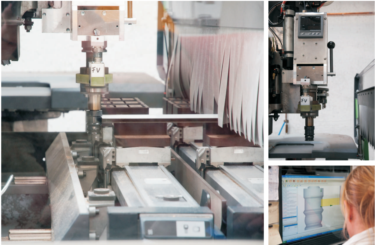
Einsatz des Thermoglättadapters an einer Biesse-Maschine
